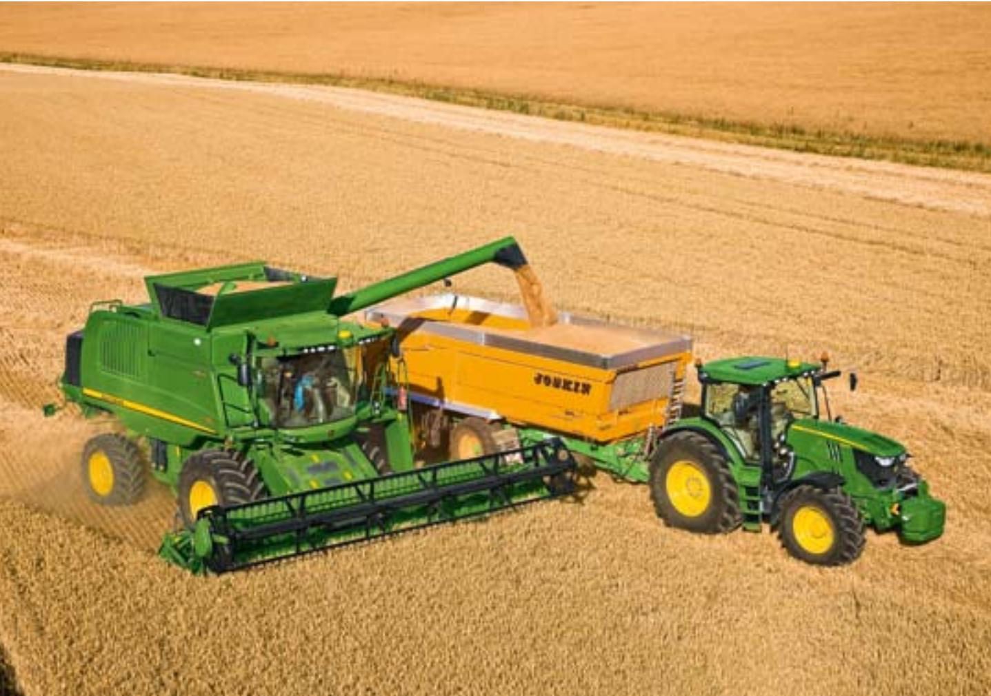
Vysokorychlostní vysýpání při práci: Díky elektronickému systému řízení motoru dochází ke krátkodobému navýšení výkonu motoru po dobu vysýpání, pokud vysýpáte za chodu.
