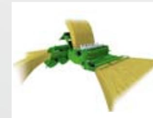
Pokud nechcete rozmetat plevy pomocí drtiče, stačí změnit polohu klapek usměrňujících tok plev. Nyní můžete rozmetat plevy do stran jako s konvenčním rozmetadlem plev.
