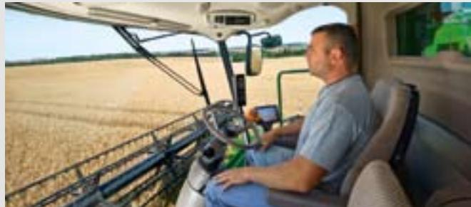
V nové a prostornější kabíně Premium se cítí obsluha dobře i po dlouhém pracovním dni. Logicky umístěné ovládací prvky usnadňují ovládání. Klimatizace, pneumaticky odpružené sedadlo, úhlově a výškově nastavitelný volant jsou dnes již samozřejmostí.
