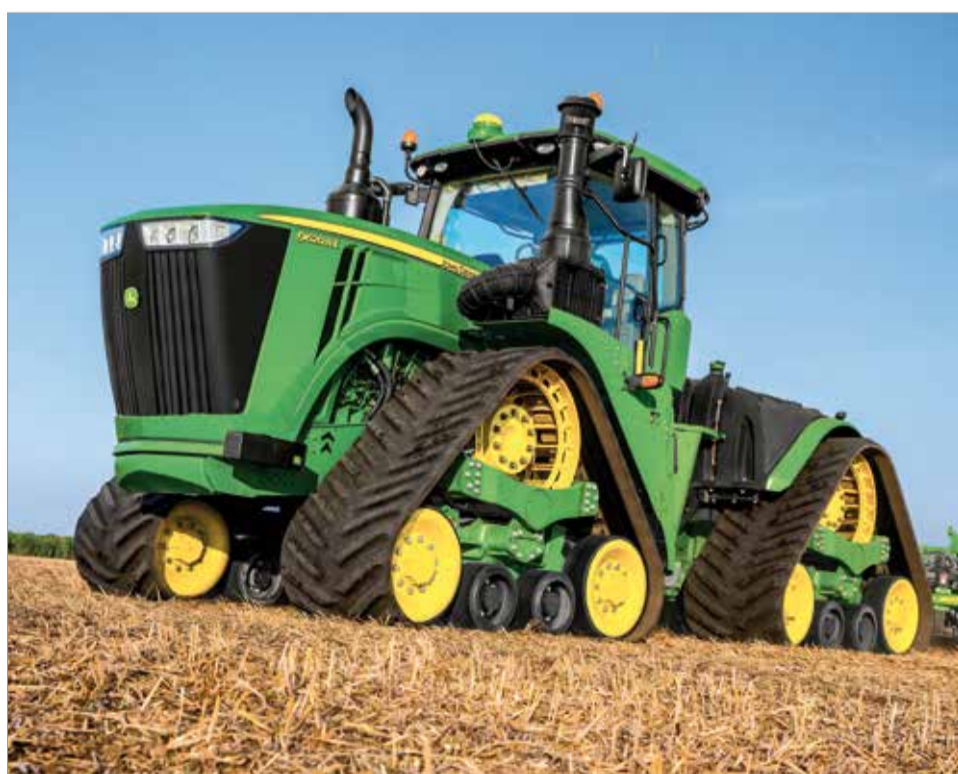
Očekávanou novinkou roku 2016 u značky John Deere je také představení pásového kloubového traktoru John Deere 9RX. Na listopadové výstavě Agritechnika v německém Hannoveru byl také představen největší kloubový traktor na pásovém podvozku a to model 9620RX. Tyto traktory se místo kol chlubí čtyřmi stejně velkými „pásovými podvozky“ a dosahují výkonu od 470 HP až po 620 HP.
