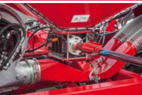
Kompaktní výsevní ústrojí Přesné dávkování s elektrickým pohonem
