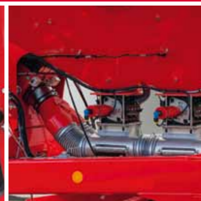
Pronto Grain & Fertilizer pro společné ukládání osiva a hnojiva na seťové lůžko.
