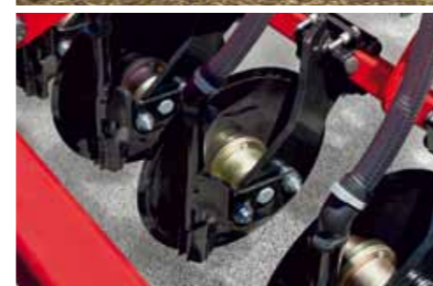
PPF botka Bezúdržbová přihnojovací botka s vysokým přítlakem
