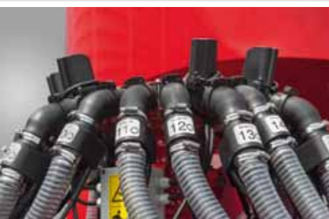
Robustní kontrolní senzory pro osivo a hnojivo
