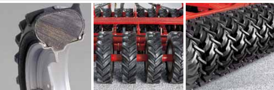
Pěnová výplň pneumatik Zvýšená stabilita při zachování šetrnosti k půdě
