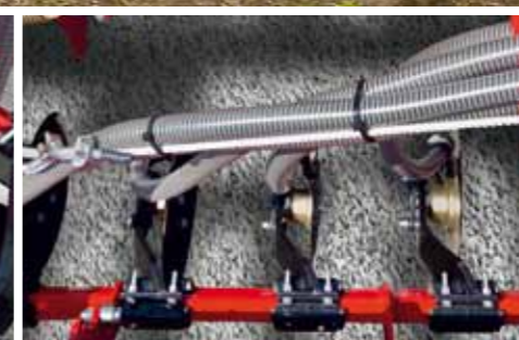
Variabilní nastavení hloubky Uložení hnojiva mezi dvě řady osiva pod pneumatikami pěchu
