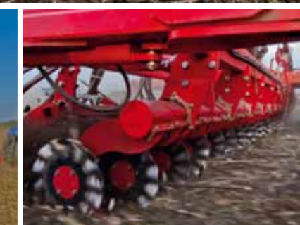
Prolamované kotouče půdy v prostoru lůžka zpracovávají s malým odporem.
