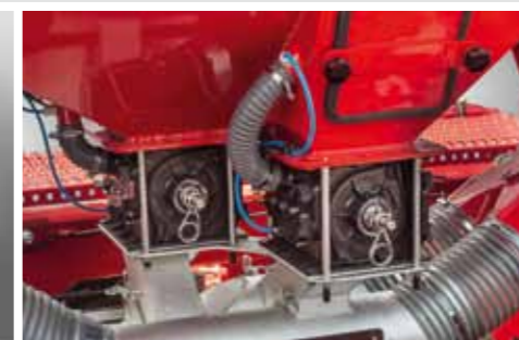
Dvě konstrukčně stejná výsevní ústrojí Přesné dávkování osiva a hnojiva
