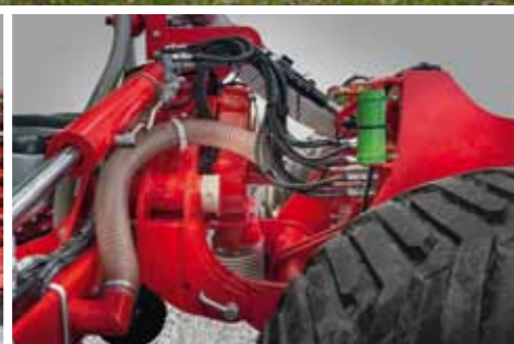
Tříbodový závěs Rychlá, jednoduchá výměna přídatných zařízení
