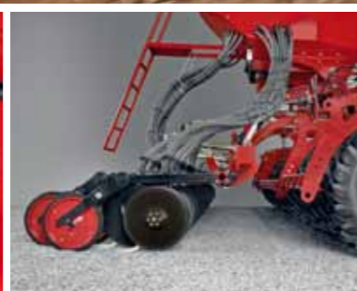
Výsevní lišta s botkami TurboDisc Pronto TD
