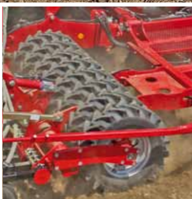
Pneumatikový pěch s optimalizovaným AS profilem Efektivní ztuhnutí před každou secí botkou
