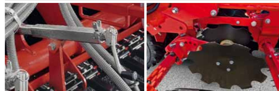
Plynulé nastavení přítlaku botek Ruční seřízení celé sekce mění předepnutí v gumových blocích poddajného uložení
