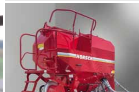
Velkoobjemový integrovaný zásobník o objemu až 5.000 l, dělení na komory 40/60
