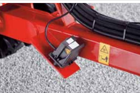
Radar Elektronické měření rychlosti bez vlivu prokluzu
