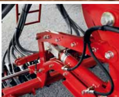
Individuální nastavení hloubky seť pomocí podložek AluClip
