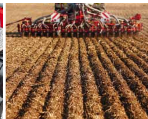
Secí botky TurboDisc ukládají osivo do půdy bez hrud a bez posklizňových zbytků.
