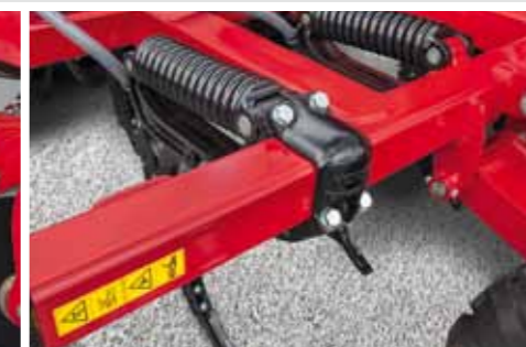
Pracovní jednotky TerraGrip III Pojistná síla 800 kg
