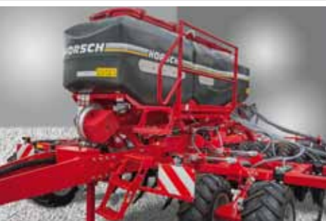
Bezpečný přístup ke krytům zásobníku
