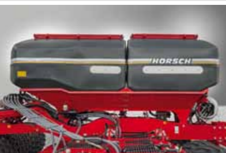
Zásobník 5.000 litrů (s dělením 30:70 pro osivo a hnojivo)
