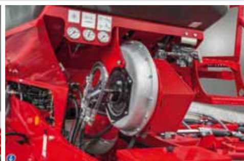
Hydraulické dmychadlo přímý pohon a přehledně uspořádané přívody
