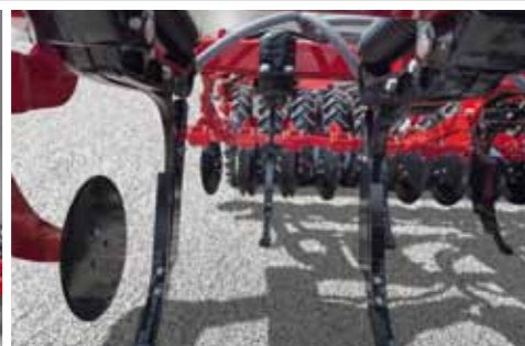
Radličky TerraGrip pracují přesně před každou pneumatikou
