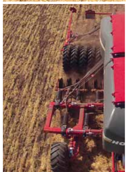
Radličky TerraGrip účinně odstraňují slámu a hroudy z horizontu výsevu
