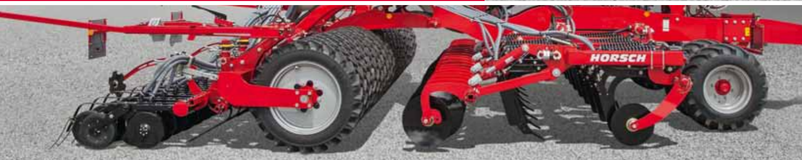
Čtyři pracovní zóny Focusu TD Secí botky TurboDisc – Klenuté talíře – Pneumatikový pěch – Jednotky TerraGrip s LD radličkami
