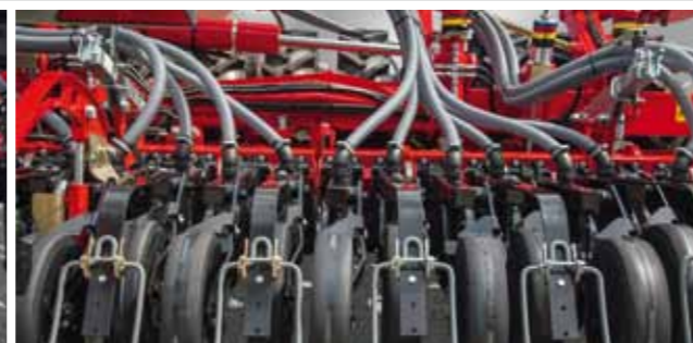
Každá secí botka TurboDisc běží středem za jednou radličkou TerraGrip a za kolem pěchu
