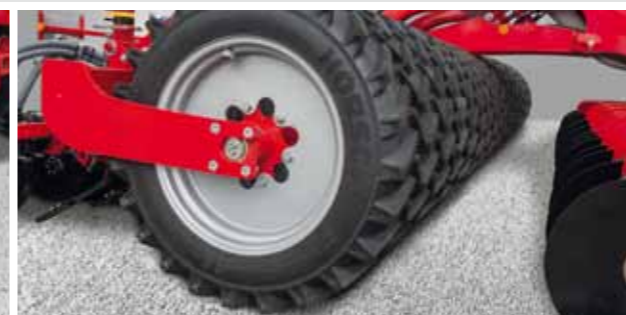
Pneumatikový pěch slouží k vedení pracovní hloubky radliček a k utužení půdy před secími botkami
