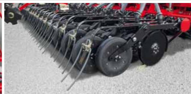
Nadprůměrná kopírovací schopnost (15 cm) secích botek TurboDisc s integrovaným zamačkávacím kolem umožňuje precizní a rovnoměrné vedení hloubky. Vysoký přítlak až 120 kg na každé botce slouží pro jejich klidný běh při každé pracovní rychlosti.
